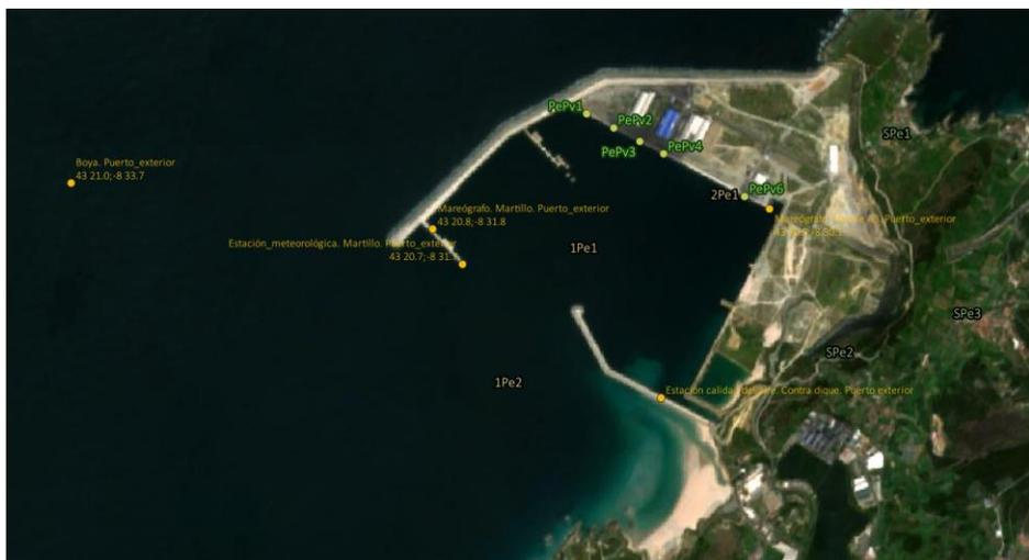
Instrumentación y puntos de muestreo en el puerto exterior
